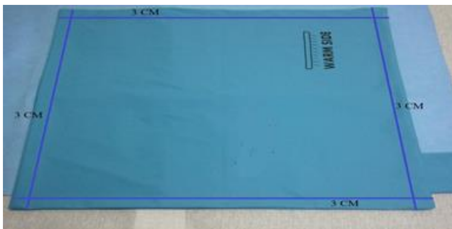
Bild 13 - Kaltbereiche der Heizpad's
