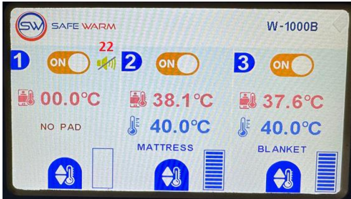
Bild 6 - Ansicht des Steuergeräts W-1000/W-1000B- Alarmansicht
